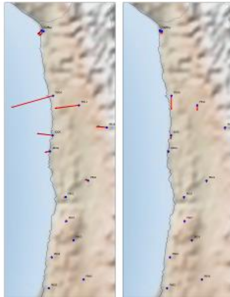
Figura 2: Ajuste de las mediciones GPS incluidas en la inversión de la Falla Finita para el terremoto de Iquique, 2014
