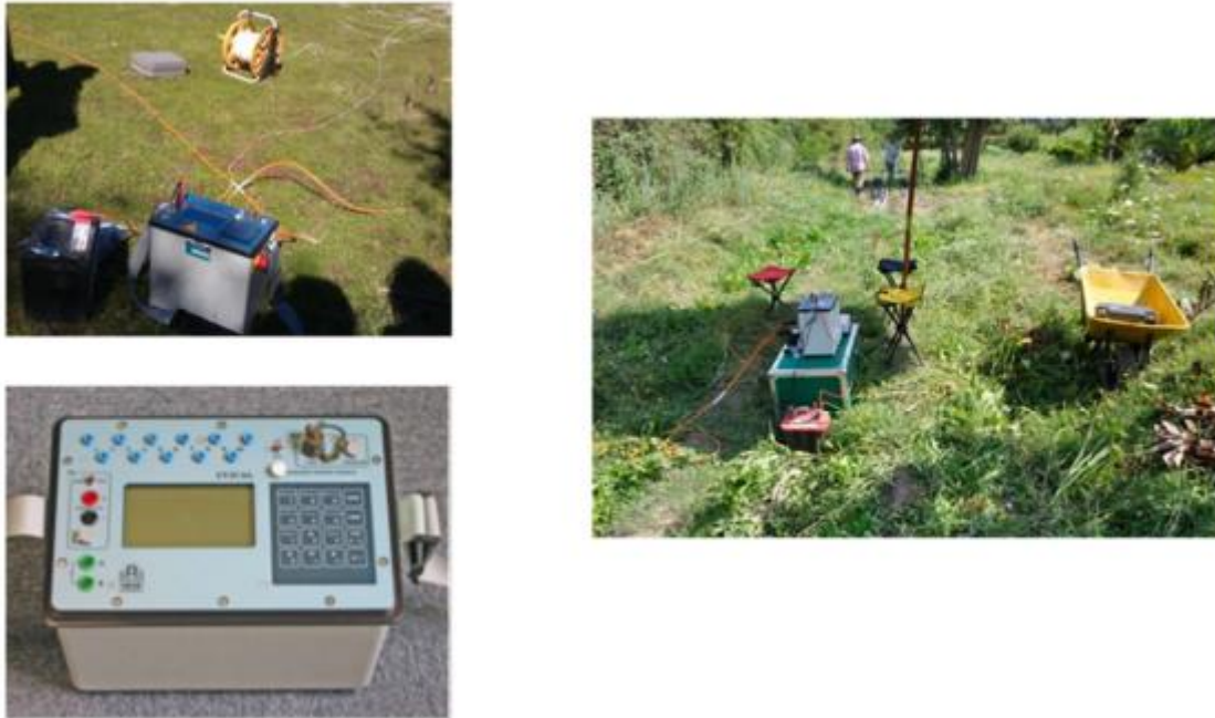
Figura 6: Equipo de medición de resistividad e IP, modelo Syscal, Pro de Iris Instruments.
