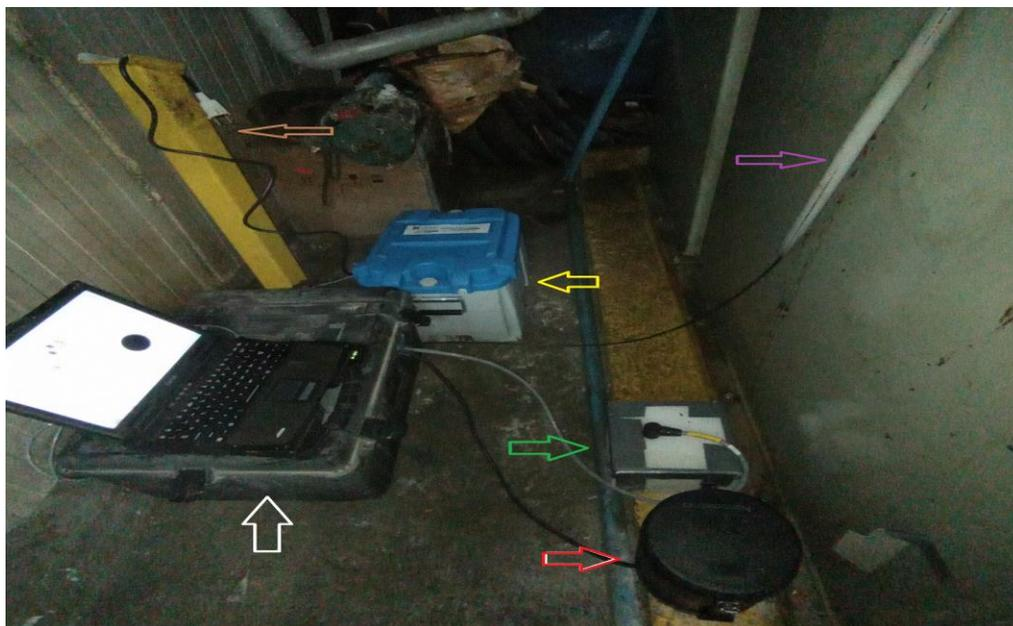
*Imagen 1. Estación sismológica y sus componentes. Caja Pelican (flecha blanca), caja blanca/azul (flecha amarilla), Salida de corriente (flecha marrón), salida al GPS (flecha purpura), acelerómetro (flecha verde) y velocímetro (flecha roja).*
