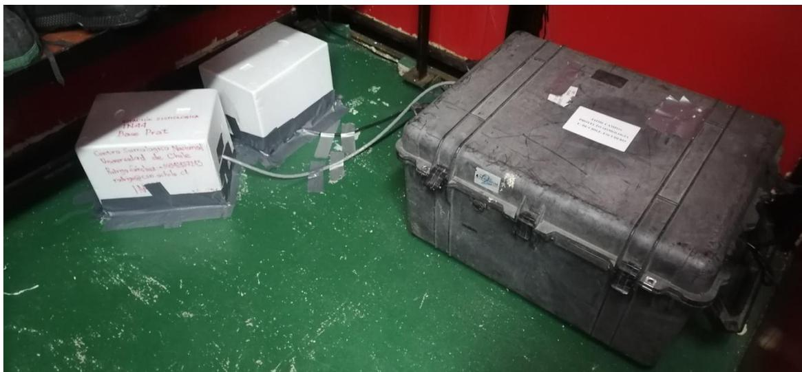
*Imagen 3. Reinstalación de la estación IN44. Dentro de la caja Pelican se encuentran los dispositivos para la carga, digitalización y almacenamiento de los datos, mientras que*
