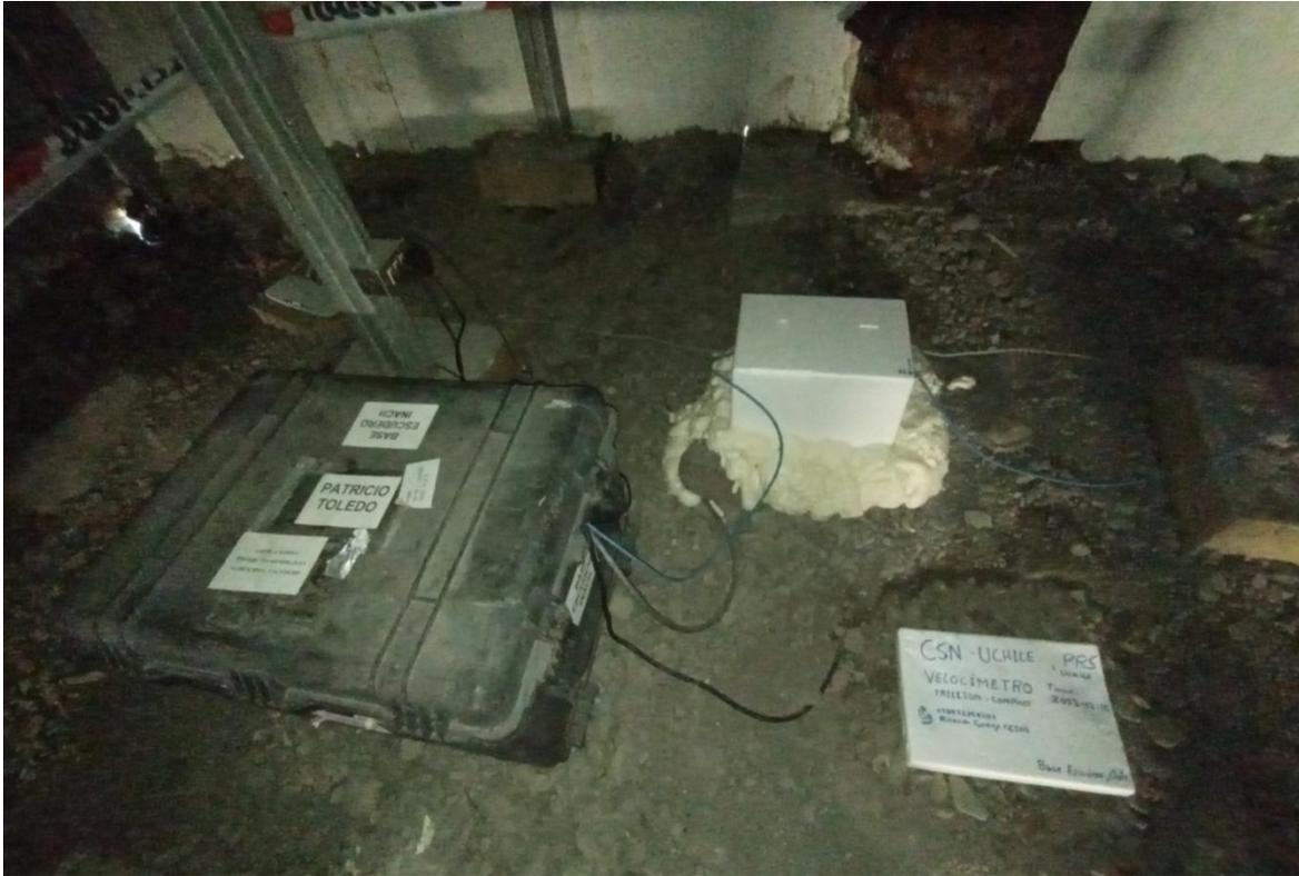
*Imagen 4. Complementación de la estación IN43. Dentro de la caja Pelican se encuentran los dispositivos para la carga, digitalización y almacenamiento de los datos. Por otro lado, el acelerómetro se encuentra dentro de la caja blanca, intacto desde su instalación el 2021, mientras que el velocímetro recién incorporado se encuentra bajo la tapa blanca. Para más detalles de los equipos al interior, revisar informe previo de la estación.*
