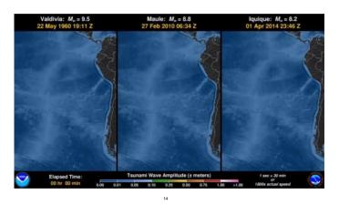
A través de los modelamientos numéricos, se simula la propagación del tsunami en el mar. Esto permite extraer los valores de inundación en la costa.
